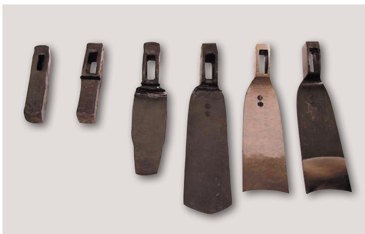
製作資料 鍛造工程見本(研究所蔵)
