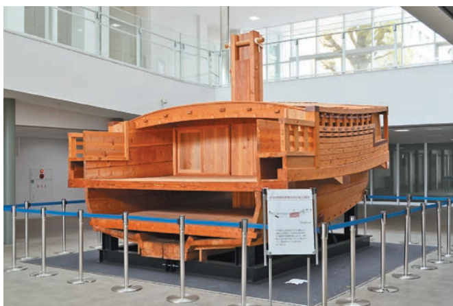
帆船帆柱部分模型 断面前方
